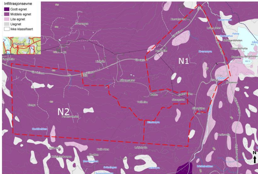
Figur 89 Infiltrasjonsevnen for løsmasser i planområdet (planområdet er omtrentlig indikert). Kilde: Kart hentet fra NGU.
