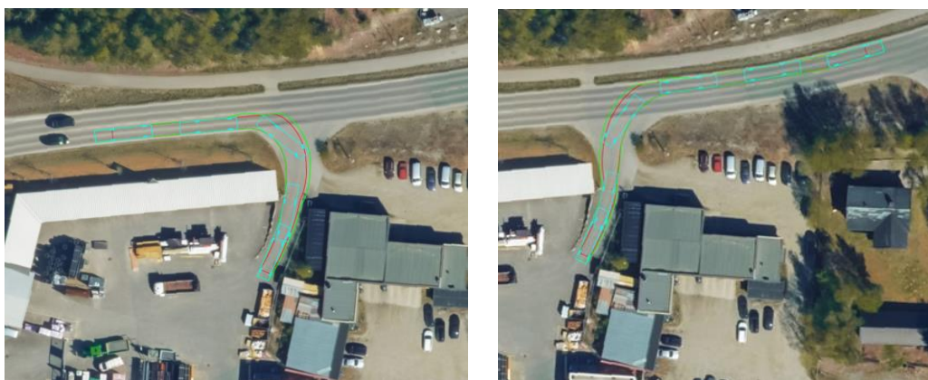
Figur 27: Sporinganalyse for lastebil i krysset mot Storgata vestfra og østfra og inn til Byggmakk
