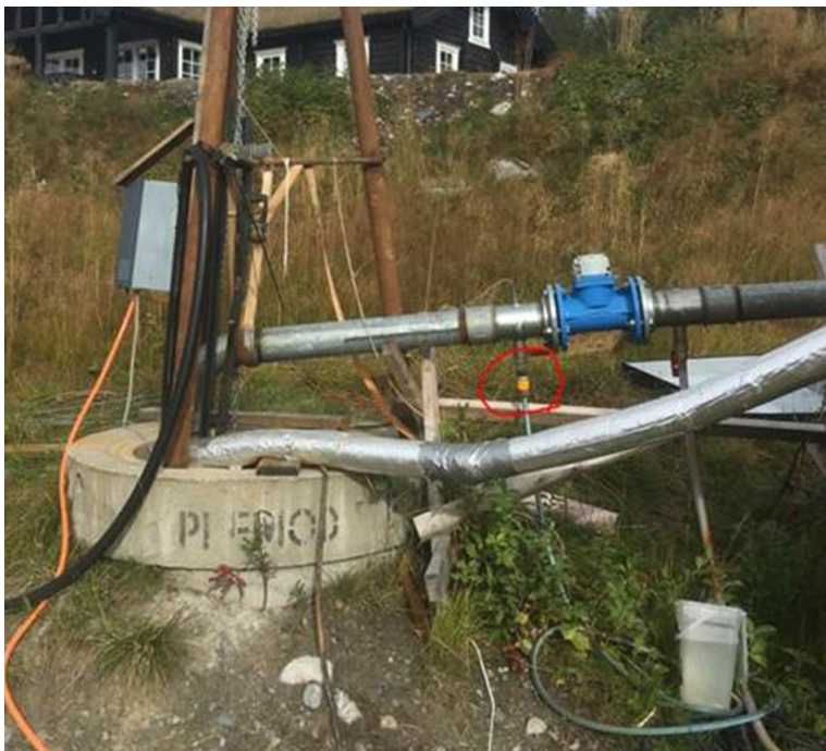
Figur 13: Prøvepumpingsopplegg fra brønnen. Prøvetakingslange som gav høye verdier av kimtall er vist med rød sirkel
